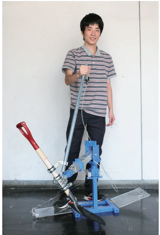
試作中の足踏み式ショベリングツール
