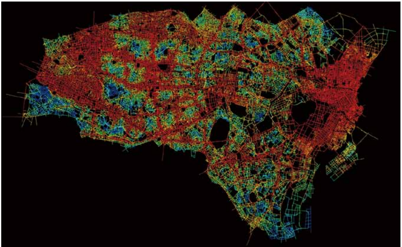
2500分の1という詳細な地形図をもとに東京中心部の街路5万3千本をSpace Syntax理論によって分析して、ネットワークのつながりの強弱を可視化した。(作成 高野裕作)
